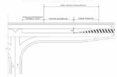
FIGURA 8.7. CARRIL CENTRAL DE ACCELERACIÓN CON TRAMO DE ALMACENAMIENTO Y ESPERA PARA MANIOBRAS DE GIRO A LA IZQUIERDA.
